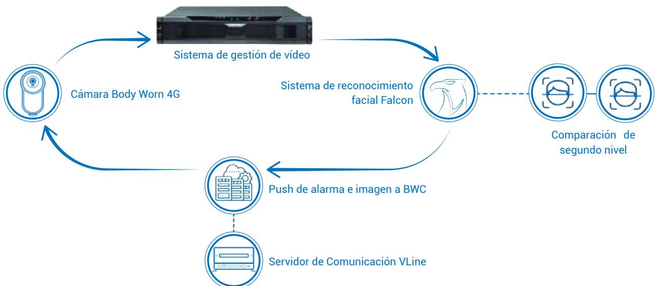
Esquema práctico de funcionamiento del Reconocimiento Facial Falcon utilizando cámaras BWC, VLine y Servidor Falcon
