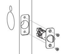
Coloque el cerradero en el orificio lateral y fijelo con los tornillos de madera adjuntos en el paquete
