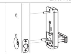
Coloque la junta de goma resistente al agua entre el panel frontal y la puerta
