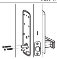
Coloque la junta de goma entre la puerta y la base del panel trasero. Fíjelo con dos tornillos M4
