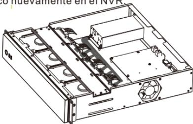
5. Conecte un cable de alimentación SATA y un cable de datos SATA al disco.
