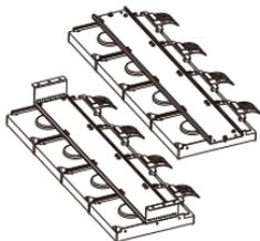
4. Instale el soporte del disco nuevamente en el NVR.
