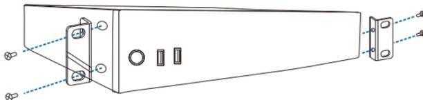
4. Coloque el NVR en el chasis.
