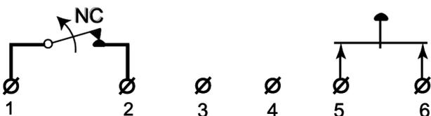
El MC 440-T es un contacto magnético universal para montaje en superficie que puede ser utilizado en sistemas de alarma y en control de accesos para proteger puertas y ventanas contra la apertura no autorizada.
