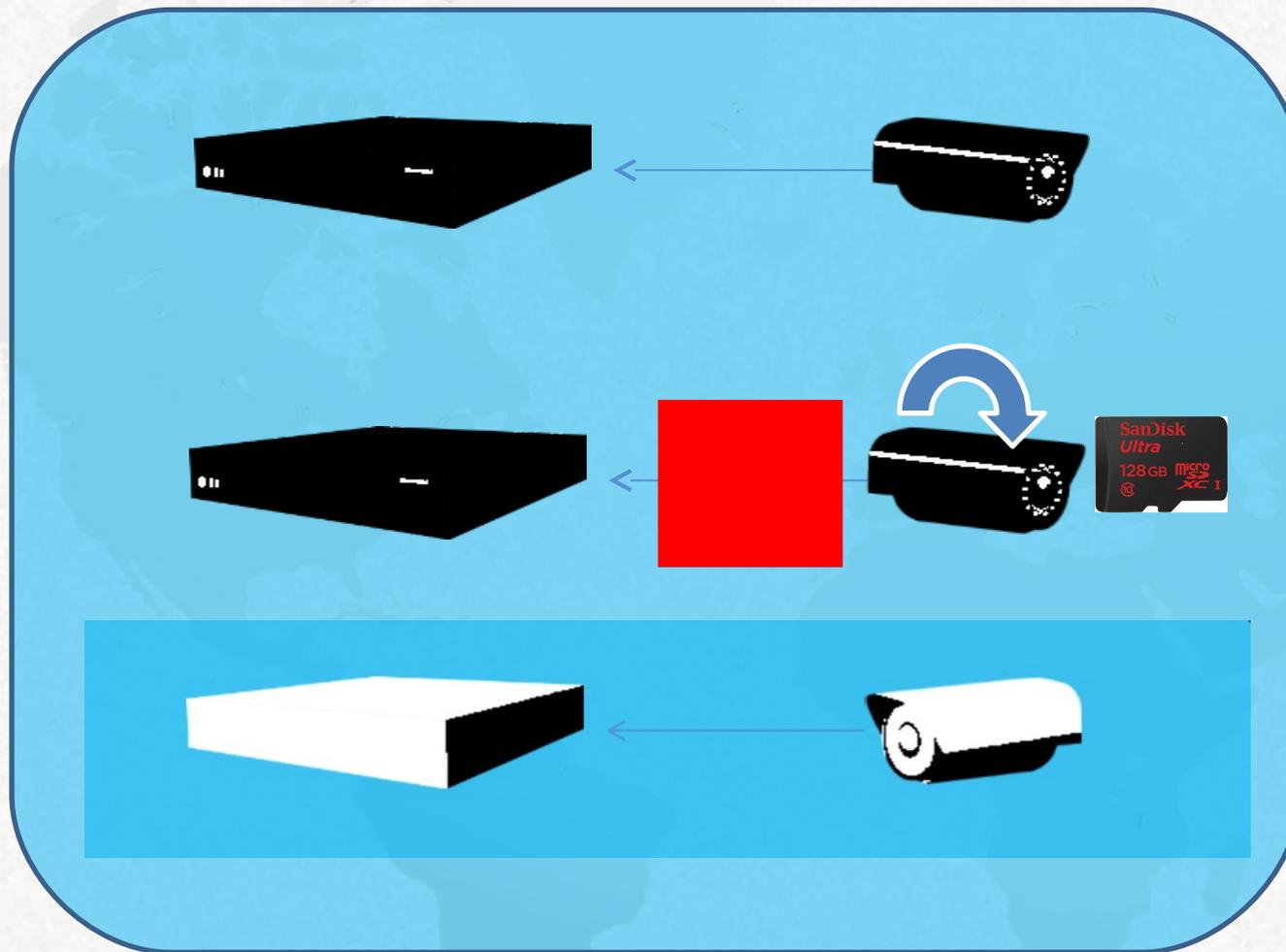
**Grabación automática en la tarjeta SD si existe una pérdida momentánea de Red. Volcará la información automáticamente al grabador cuando vuelva la conexión**
