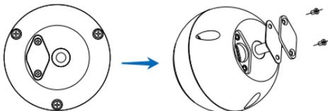
Afloje los tornillos en la base de la cámara, quite la tapa e inserte la tarjeta TF. Luego instale la tapa y apriete los tornillos.
