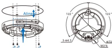
Pega la etiqueta de instalación en la pared; perforar agujeros e insertar tornillos para fijar la base en la pared.
