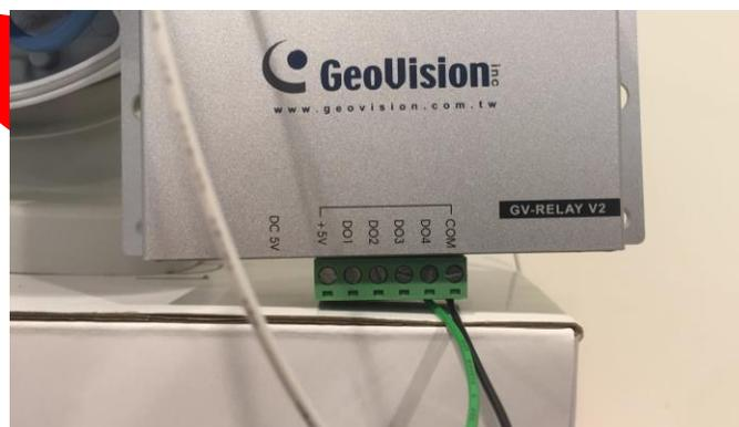
Conecte la salida (verde) y masa(negro) a la entrada del rele, y cambie asi una salida digital a un contacto seco.
